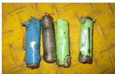
発火したリチウムイオン電池
