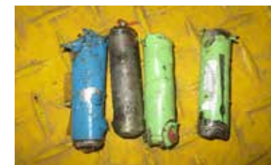
発火したリチウムイオン電池
