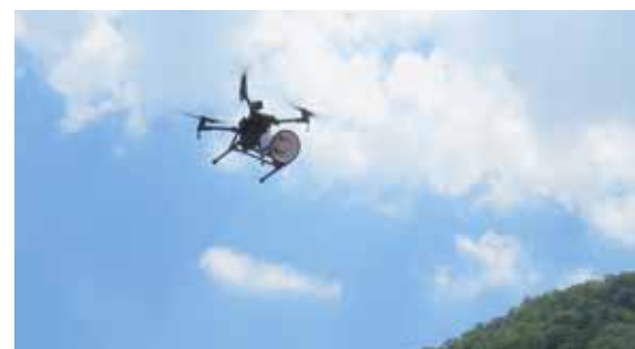
訓練で避難誘導に使用された「スピーカードローン」
