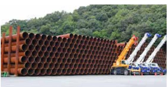
整然と積み上げられた直径1.2mの鋼管
