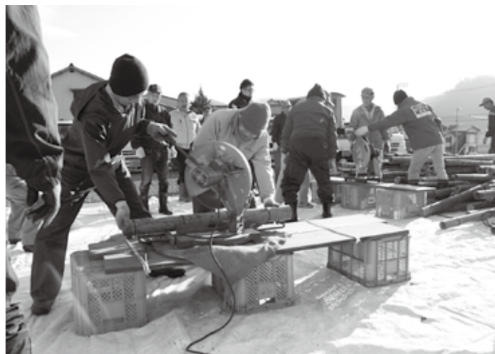
長さを合わせる刃と斜めに切る刃とに分けて切り出します
