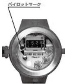
水道を使用していない状態で、このパイロットが回転していれば、水道メーターから蛇口までのどこかで漏水している疑いがあります。すみやかに町指定の水道業者に依頼して修理してください。
