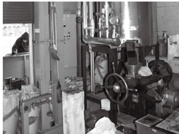
種を選別して機械を使ってひまわり油を搾油します
